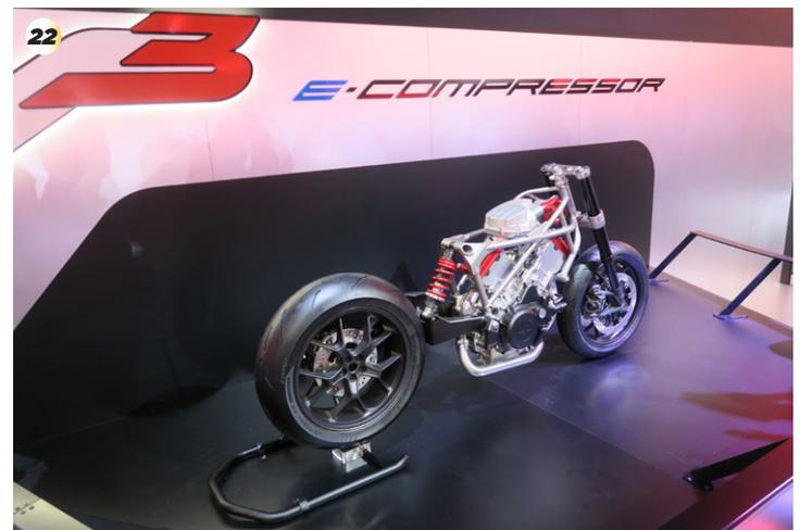
Grandissima novità dal punto di vista tecnico/ingegneristico presentata dal colosso del sol levante è un concept (prototipo): **“ICE Concept”** ovvero un propulsore termico tre cilindri a V destinato a cilindrata medio alte, affiancato da un compressore elettrico. **V3 E-Compressor** il nome di questo motore innovativo che sicuramente non rimarrà un prototipo, ma equipaggerà moto sportive, come è intuibile dal telaio esposto. **(FOTO 23)**
