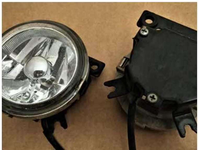
Svitare solo le 2 viti in alto senza toccare la vite in basso, che serve a regolare l'inclinazione. Staccare gli spinotti avendo cura di premere la linguetta che li blocca. Voltare il faretto e svitare le 3 viti a stella situate posteriormente, a questo punto potete levare la vecchia lampadina sganciando la molletta di fissaggio e staccare lo spinotto (all'interno vi troverete una protezione di plastica nera che isola lo spinotto, va aperta per poterlo sfilare).
