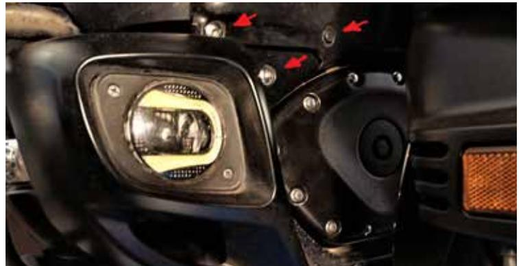
Rimuovere le 6 viti a brugola e le 2 clips che lo bloccano (attenzione, una volta levate viti e clips, va allargata la carena forzandola per fare uscire gli angoli del puntale che rimangono nascosti, appunto, dietro l'aletta della carena stessa, ripetere l'operazione da entrambe i lati).
