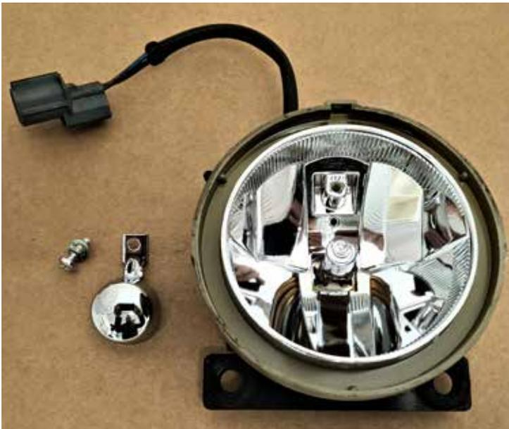
Con il faretto aperto svitare la vite a stella che fissa il cappellotto cromato, eliminarlo, riavvitare la vite senza cappellotto (in questa situazione potete approfittarne per pulire l'interno del vetrino e con molta attenzione anche le parabole, con un panno morbido).
